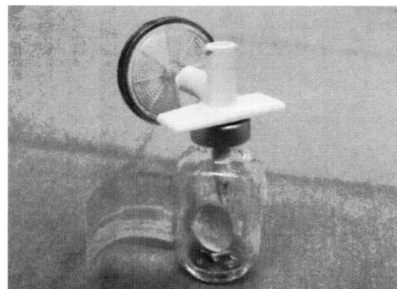
図4 バイアルゴム栓部の脱落
