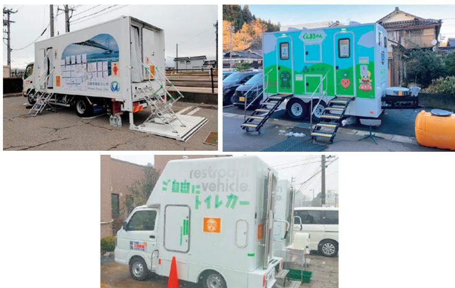
図4 車載トイレ (トイレカー)
