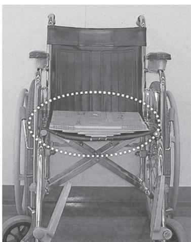
図7 車椅子の座面を段ボールでたわみを無くした状態
