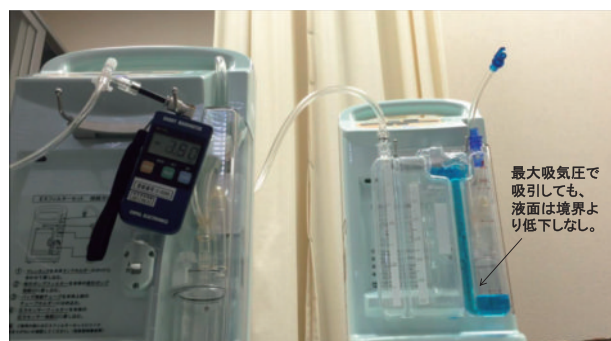
図8 50 mL water seal での努力性吸引
