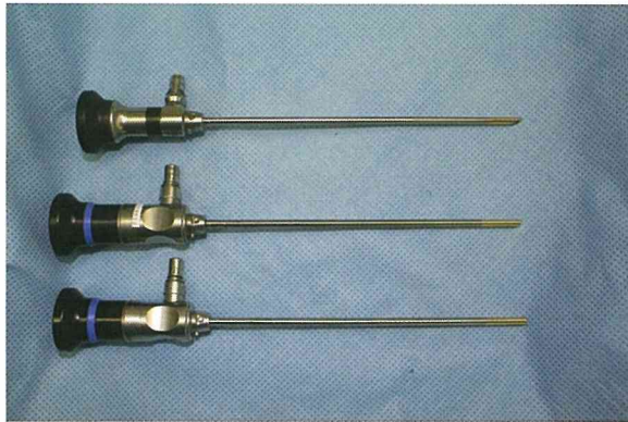
図1 硬性鏡（観察方向：0，30，70度）
