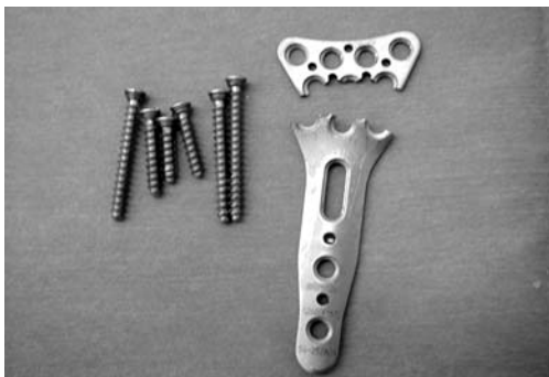
図-3 折損したプレート
