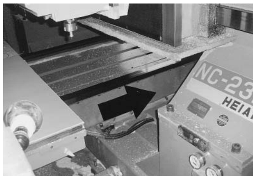
矢印歩行に作業台が動き、機械との間に挟まれ受傷
