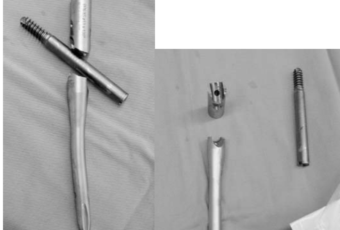
ラグスクリュー通過部で折損している 図-6 抜去後のインプラント
